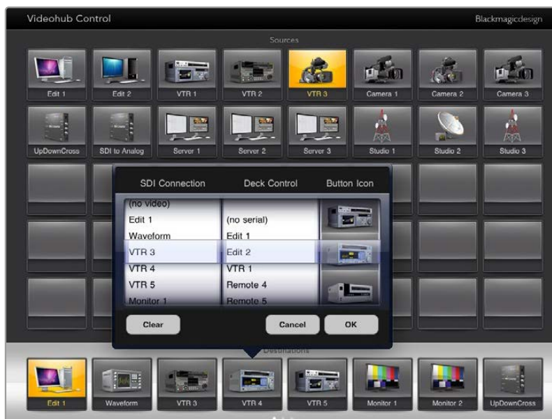
La fenêtre Videohub Button Setup vous permet de régler la source ou la destination SDI, le contrôle RS-422 et l'icône du bouton
