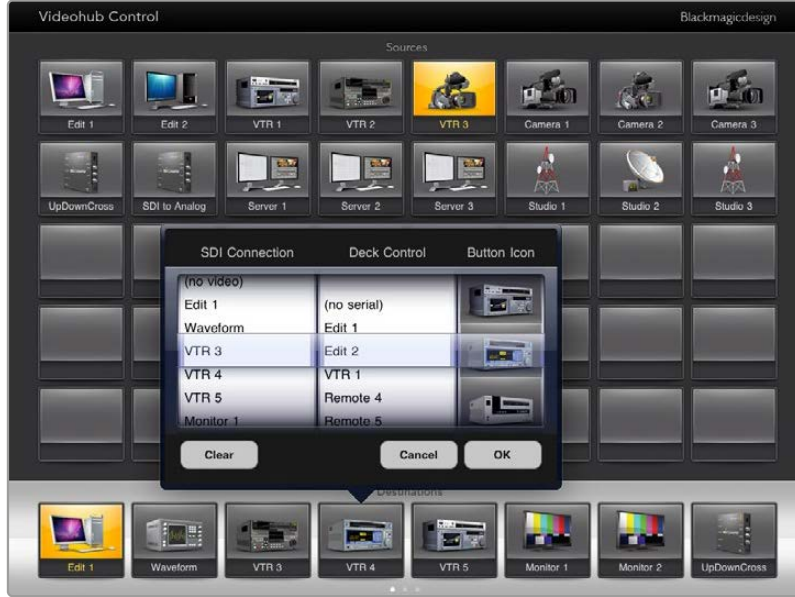
Videohub Button Setup penceresi; SDI giriş veya çıkış bağlantısını, RS-422 deck kontrolünü ve arayüz butonu için iconu ayarlamanıza imkan tanır
