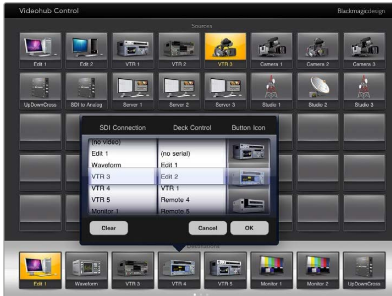
Im Videohub Button-Setup-Fenster können Sie SDI-Ein- und Ausgaben, die RS-422-Decksteuerung und die Symbole für Icons einrichten
