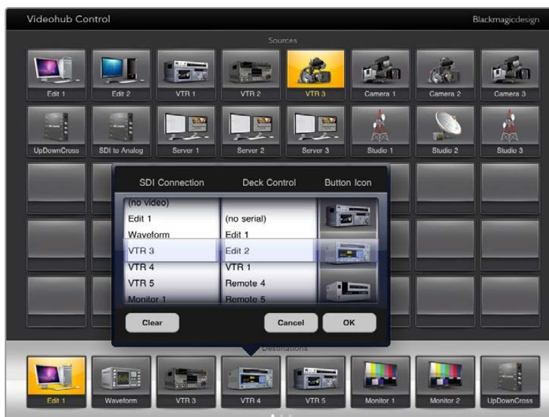
Окно настройки кнопок позволяет выбрать вход или выход SDI, порт RS-422 для управления деккой и значок для кнопки
