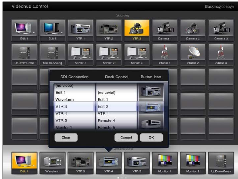
Videohub Button Setupウィンドウ。該当のプッシュボタンのSDI入出力の接続、RS-422デッキコントロール、アイコンを設定可能。
