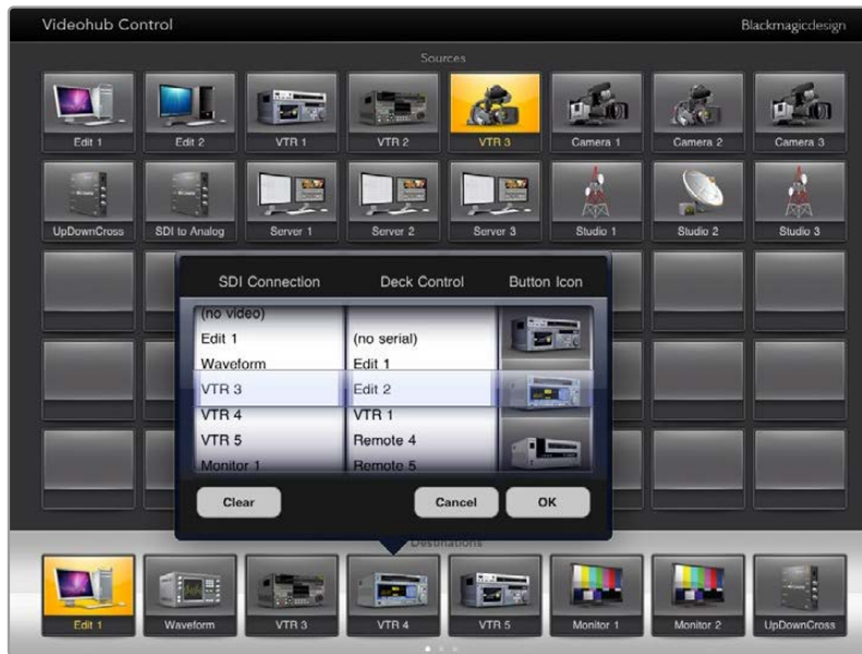
Videohub Button Setup 창에서 SDI 입력 또는 출력 연결, RS-422 데크 컨트롤, 푸시버튼의 아이콘을 설정할 수 있습니다
