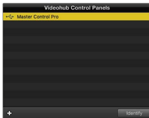
Alle via Ethernet oder USB angeschlossenen Steuereinheiten werden im Videohub Control Panel Bereich mit einem entsprechenden Icon aufgelistet
