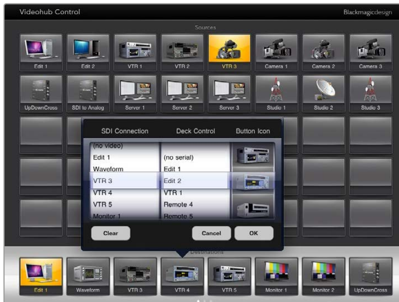
A janela de configuração de botões Videohub permite que você defina a conexão de entrada ou saída, controle de deck RS-422 e o ícone para o botão.
