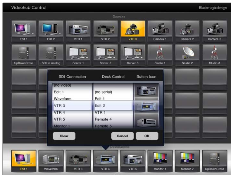
Okno Videohub Button Setup pozwala ustawić połączenie wejścia lub wyjścia SDI, sterowanie dekiem RS-422 oraz ikonę dla przycisku.
