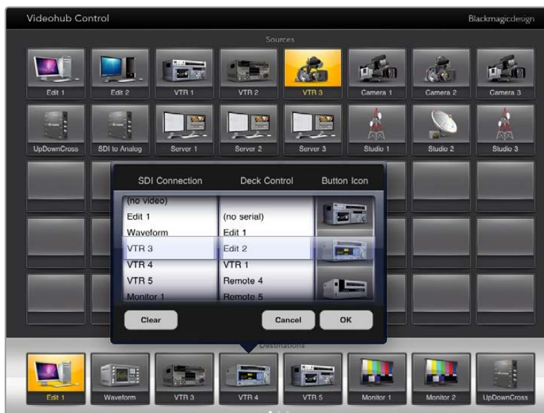
Вікно налаштування кнопок дозволяє вибрати вхід або вихід SDI, порт RS-422 для керування декою та піктограму для кнопки
