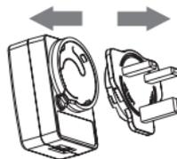
**1** Um einen Stecker (A) zu befestigen, platzieren Sie ihn auf der Adapterbasis (B). Dann drücken Sie ihn leicht auf und drehen Sie ihn im Uhrzeigersinn.
