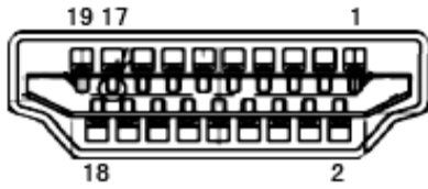
Câble de signal d'affichage couleur à 19 broches
